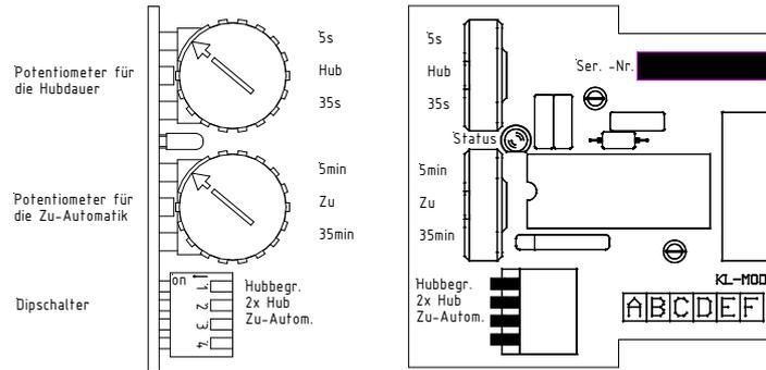
Abbildung 9: Komfort- Lüftungsmodul
