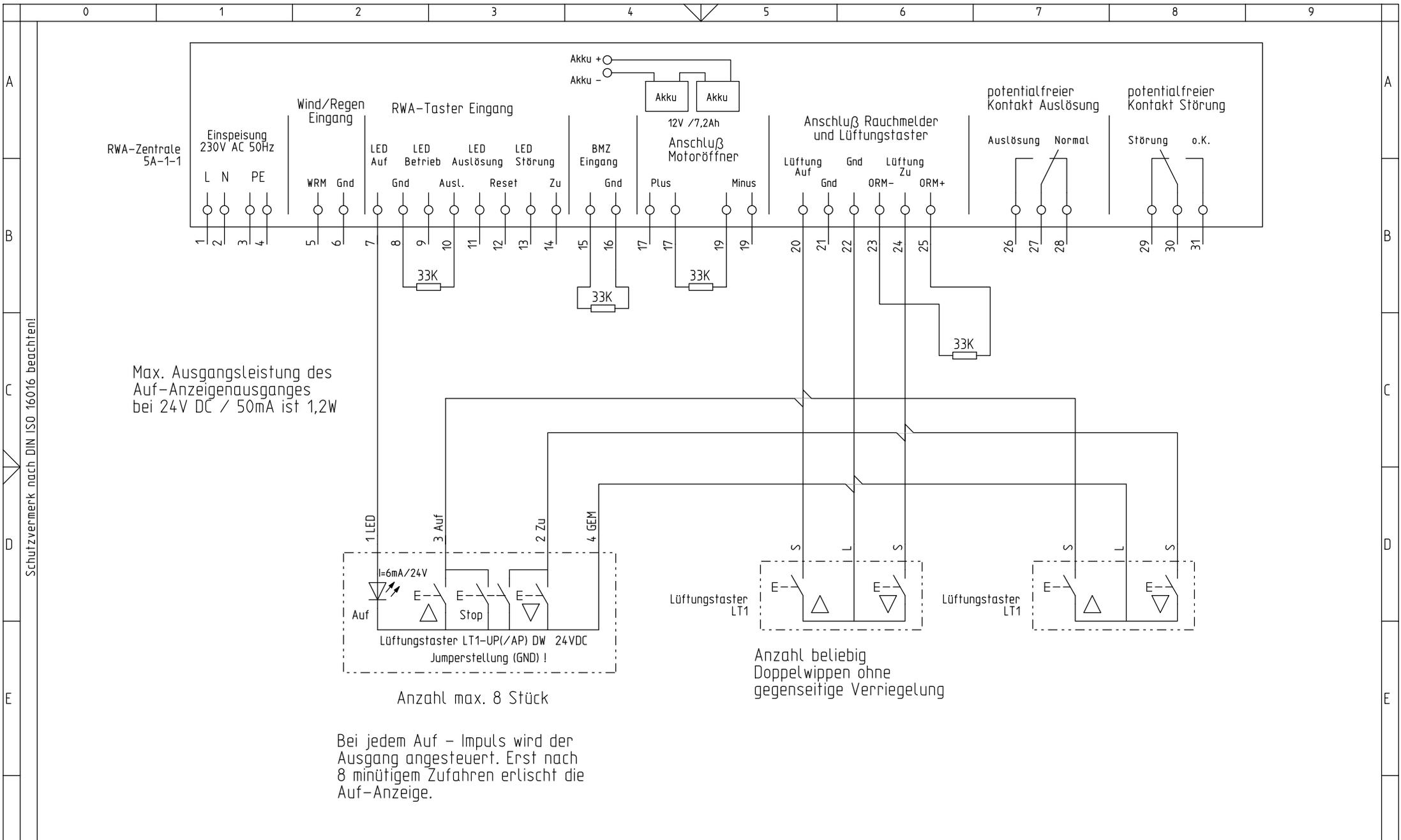
Max. Ausgangsleistung des Auf-Anzeigenausganges bei 24V DC / 50mA ist 1,2W
