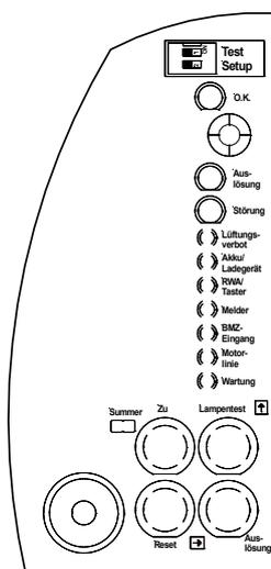
Hierfür gibt es den DIP-Schalter „Setup“, der zur Veränderung der Programmierung, unter gleichzeitigem Drücken der Taster „Reset“ und „Lampentest“ , auf ON gestellt werden muss.
