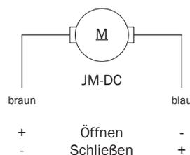
Der Anschlussbereich der Motorzuleitung muss in IP 65 ausgeführt werden.
